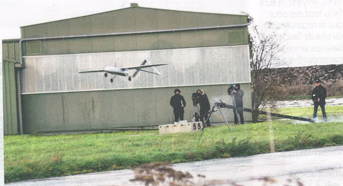
Le drone est propulsé par une catapulte et peut ensuite parcourir plusieurs kilomètres. Survey Copter, la filiale d'Airbus, est spécialisée dans l'étude et la réalisation de drones pouvant intervenir dans des milieux hostiles ou difficilement accessibles.
